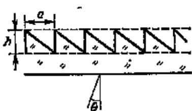
37. Рассчитать и проанализировать дифракционную картину при нормальном падении света на пилообразную решетку (см. рисунок), сделанную из стекла с показателем преломления  $n$ . Число зубьев решетки равно  $N$ ,  $a \gg h$ . Длина волны падающего света равна  $\lambda$ .
