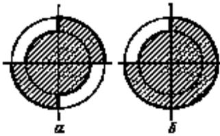
31. Между точечным монохроматическим источником света и точкой наблюдения перпендикулярно соединяющей их линии помещен экран, состоящий из секторов двух кругов (см. рисунок). Радиус одного из них равен радиусу 1-й зоны Френеля, другого - радиусу 2-й зоны Френеля. Определить интенсивность света в точке наблюдения, если в отсутствие экрана она равна  $I_0$ .
