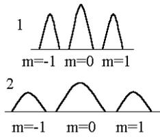
39. На рис. в одинаковом масштабе изображены максимумы нулевого и первого порядков двух дифракционных решеток. Выберите правильное соотношение их разрешающих способностей и угловых дисперсий
