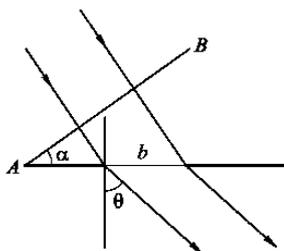
33. На щель ширины  $b$  положена стеклянная призма с показателем преломления  $n$  и преломляющим углом  $\alpha$  (см. рисунок). На грань АВ призмы нормально падает плоская монохроматическая волна. Найти направления на нулевой максимум и минимумы в дифракционной картине Фраунгофера.
