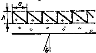
**37.** Рассчитать и проанализировать дифракционную картину при нормальном падении света на пилообразную решетку (см. рисунок), сделанную из стекла с показателем преломления  $n$ . Число зубьев решетки равно  $N$ ,  $a \gg h$ . Длина волны падающего света равна  $\lambda$ .
