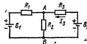
2. Три источника тока с ЭДС  $\varepsilon_1=11$  В,  $\varepsilon_2=4$  В и  $\varepsilon_3=6$  В и три реостата с сопротивлениями  $R_1=5$  Ом,  $R_2=10$  Ом и  $R_3=2$  Ом соединены, как показано на рисунке. Определите силы токов  $I$  в реостатах. Внутреннее сопротивление источника тока пренебрежимо мало.
